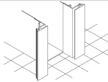
FISSARE IL NASELLO GUIDA UTILIZZANDO LA VITE 4x35 SE IL CASSONETTO FOSSE STATO MONTATO SOTTO IL LIVELLO DEL PAVIMENTO UTILIZZARE DEGLI SPESSORI.
