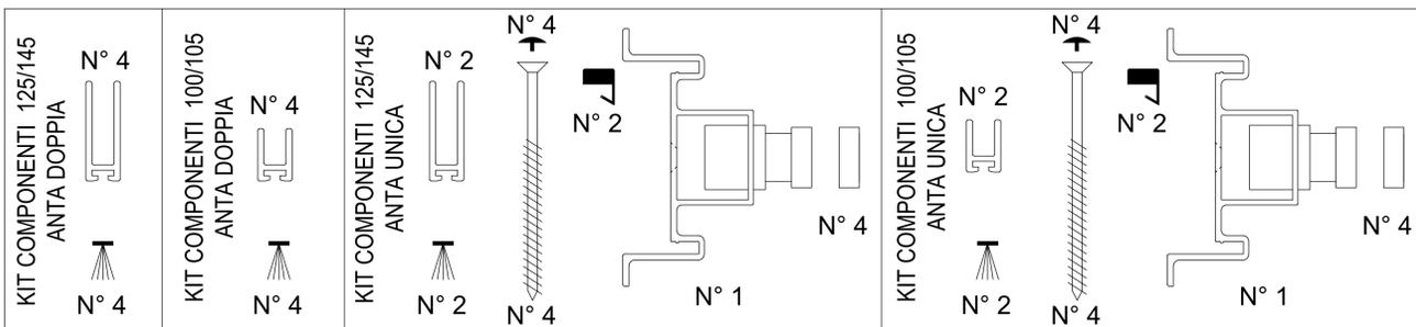
ACCESSORI IN DOTAZIONE CON LA PORTA MIRR (DA COMPLETARE CON GLI ACCESSORI "DA UTILIZZARE" DEL CONTROTELAIO) ✓
