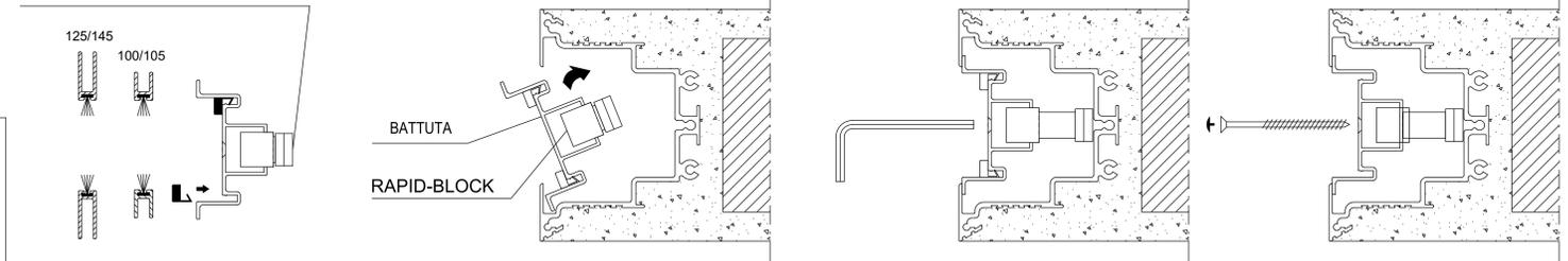
SE NECESSARIO ADATTARE IN ALTEZZA LA BATTUTA IN ALLUMINIO. INSERIRE LA BATTUTA REGOLARE IL RAPID-BLOCK. FISSARE CON LE VITI DA 4.5x60.
