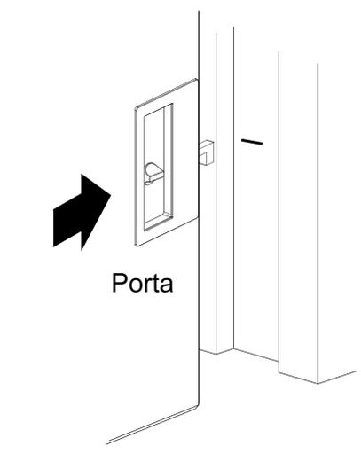
DOPO AVER MONTATO LA SERRATURA FARE SCORRERE LA PORTA CON IL GANCIO SERRATURA CHIUSO SEGNAANDO IL MONTANTE DI BATTUTA
