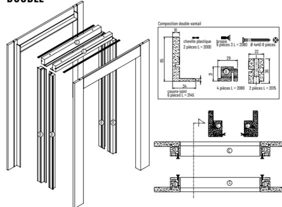
Les éléments du Kit de finition et les couvre-joints devront être coupés sur mesure lors de l'installation.
