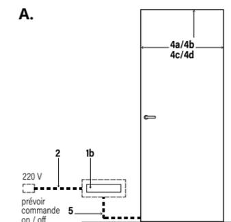
A. Fonctionnement : allumage et extinction par dispositif (non fourni) sur alimentation principale.
