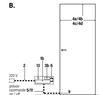
B. Fonctionnement : allumage et extinction avec fermeture/ouverture vantail.
