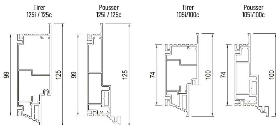
Huisserie à battant à fil de cloison enduit 105 et plaques de plâtre 100 mm - Tirer gauche • Tirer droit / Pousser gauche • Pousser droit
