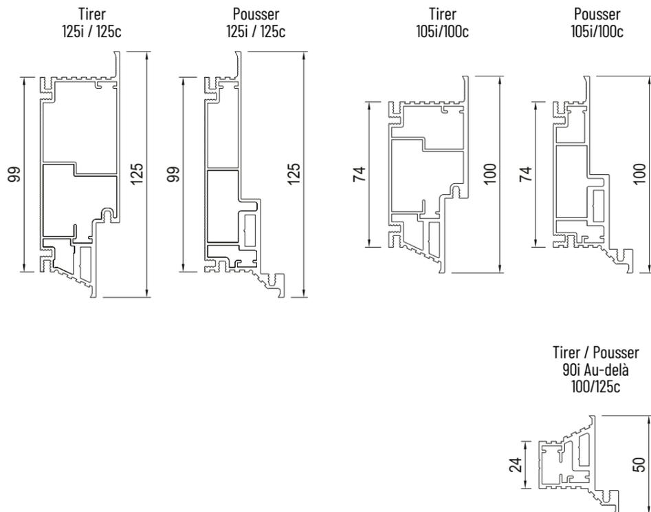
Huissérie à battant à fil de cloison enduit 90 et plus et plaques de plâtre 75 mm - Tirer gauche • Pousser droit / Tirer droit • Pousser gauche
