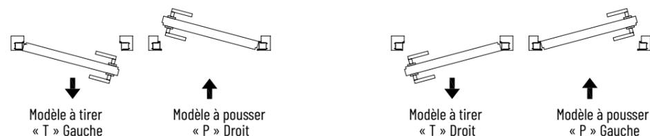
Huissierie à battant à fil de cloison enduit 105 et plaques de plâtre 100 mm - Tirer gauche • Tirer droit / Pousser gauche • Pousser droit
