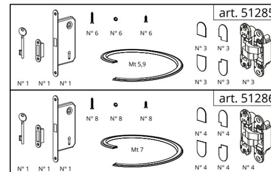
Kit cerniere 60 kg + serratura magnetica foro cilindro europeo
