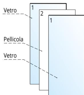
Vetro stratificato composto da due lastre di vetro (1) con interposta una pellicola di materiale plastico PVB (2) trasparente, che aderisce perfettamente alle due superfici di vetro, creando così un'unica lastra.
