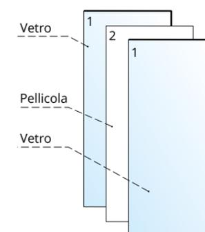
Vetro stratificato composto da due lastre di vetro (1) con interposta una pellicola di materiale plastico PVB (2) trasparente, che aderisce perfettamente alle due superfici di vetro, creando così un'unica lastra. Conformi alle norme UNI EN 14449. In caso di rottura la pellicola interna permette di trattenere i vari frammenti. Le operazioni di pulizia e manutenzione possono venir effettuate con estrema semplicità.
