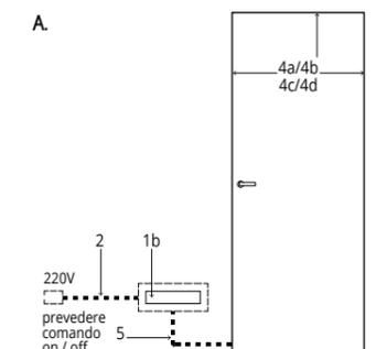
A. Funzionamento: accensione e spegnimento tramite dispositivo (non fornito) su alimentazione principale.
