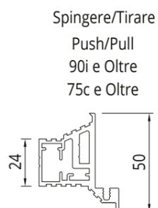
Telaio battente filomuro Intonaco 125 e Cartongesso 125 mm - Tirare SX • Tirare DX - Spingere SX • Spingere DX
