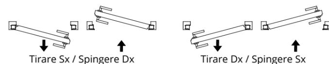
Telaio battente filomuro Intonaco 105 e Cartongesso 100 mm - Tirare SX - Tirare DX - Spingere SX - Spingere DX
