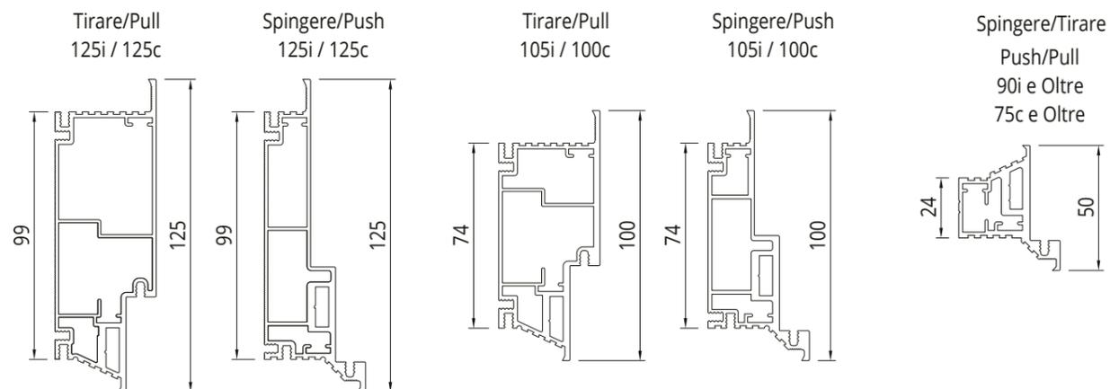
Telaio Senza traverso Intonaco 90 e Oltre e Cartongesso 75 mm
