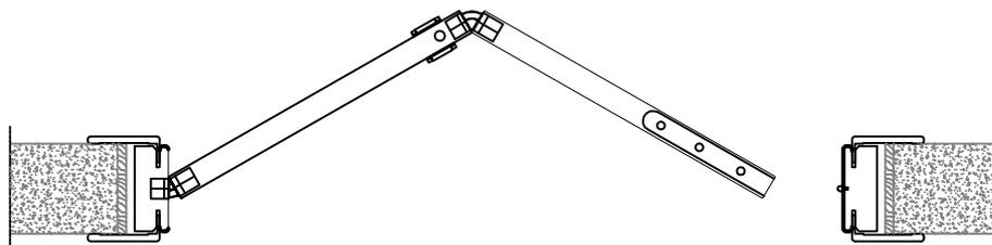
cambio apertura: ruotare di 180° porta completa di telaio
