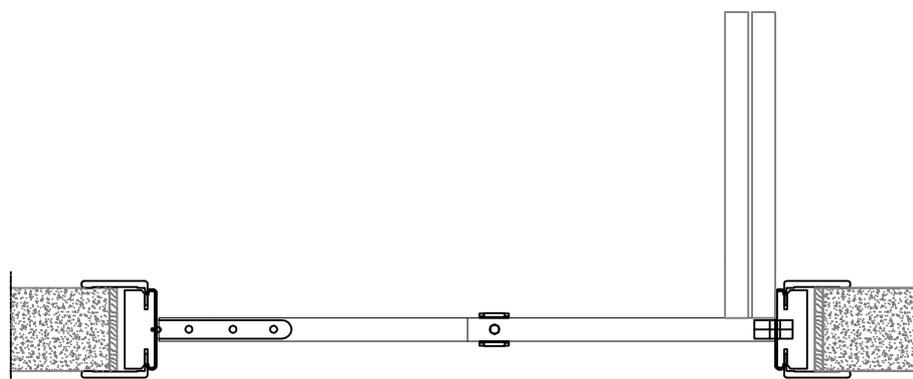
3. La porta viene fornita con serratura, maniglia, gancio di scorrimento e cerniere già installate.
